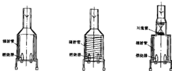
图 10-1 纯辐射立管式圆筒炉 图 10-2 纯辐射盘管式圆筒炉 图 10-3 对流—辐射立管式圆筒炉
