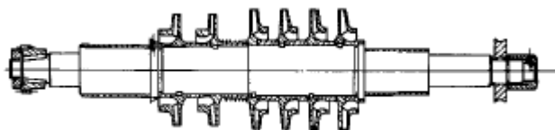
图 20-36 光轴叶轮背靠背布置
